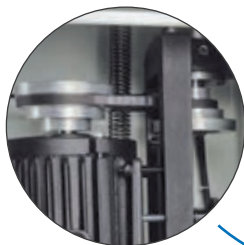
Zmena otáčok pomocou remenice
