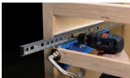
Montujte pojazdy k zásuvkám ľahko a rýchlo.
