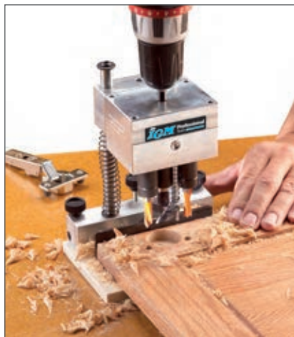
Použitie s ručnou alebo aku vrtáčkou.
