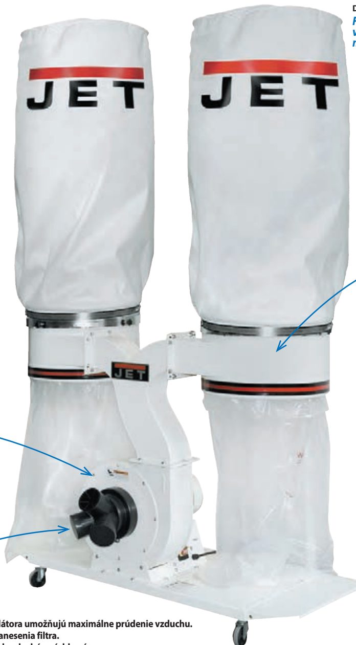
Kuželový priechod do filtračnej časti zvyšujúci účinnosť (systém VORTEX CONE)
