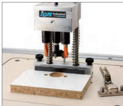
Použitie s ručnou alebo aku vrtáčkou.
