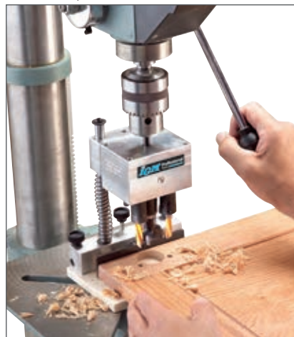
Použitie so stojanovou vrtáčkou.
